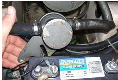
Şekil 14: Tuzlu su pompası
