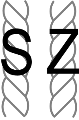
Şekil 2. S ve Z büküm
