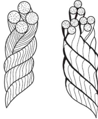
Şekil 3. Çarmık büküm (solda) ve Kablo büküm (sağda)
