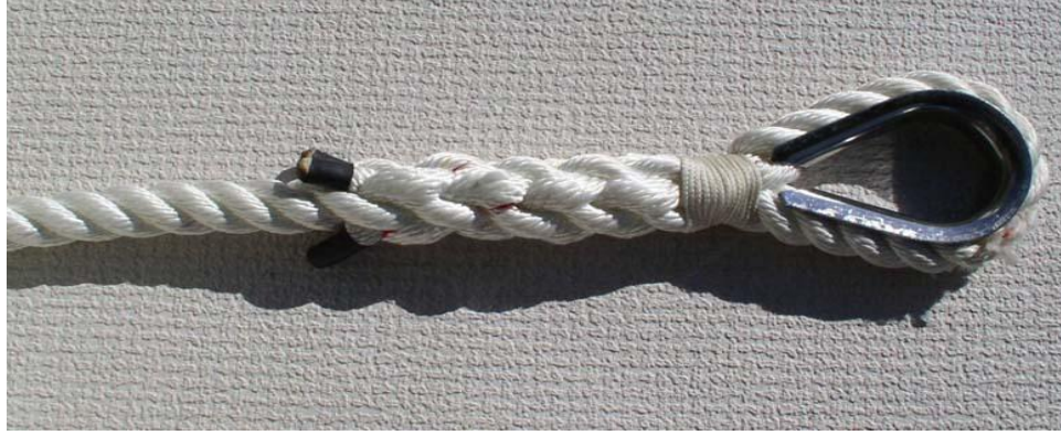
Resim 16. Eye splice yapılmış bir ipteki radansa
