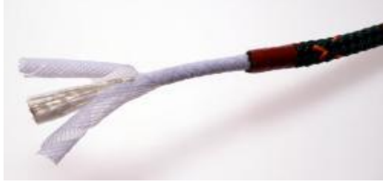
Resim 8. Paralel örgü çekirdeğin yapısı
