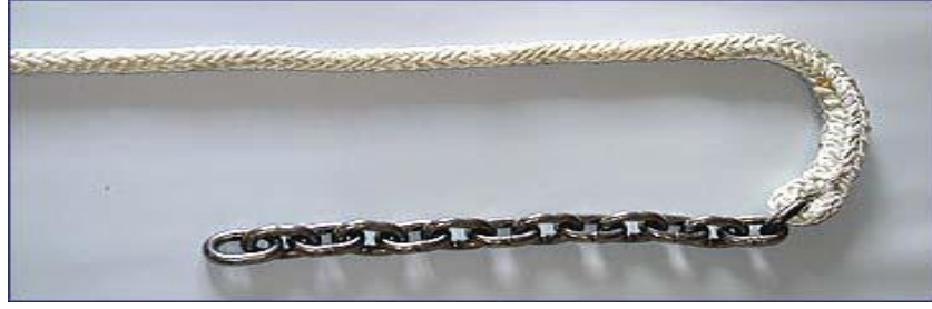
Resim 4. Ucuna demir zinciri eklenmiş naylon bir ip
