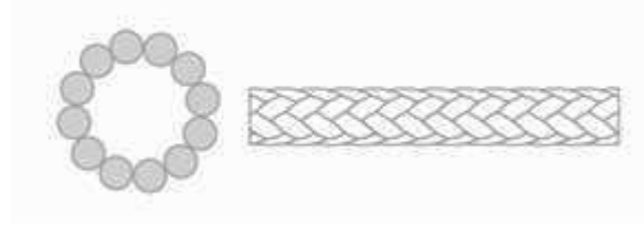
Şekil 5. İçi boş örgülü ipin yapısı
