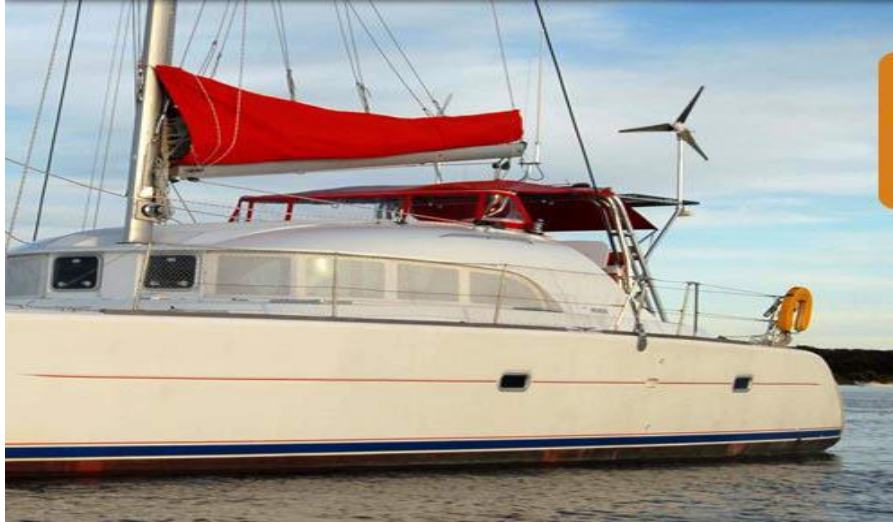
Resim 8. Rüzgar türbini takılmış bir yelkenli tekne
