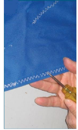
ŞEKİL 19:TIĞ YA DA TORNAVİDA GİBİ ALET KULLANARAK DİKİŞ KONTROLÜ YAPILIR
