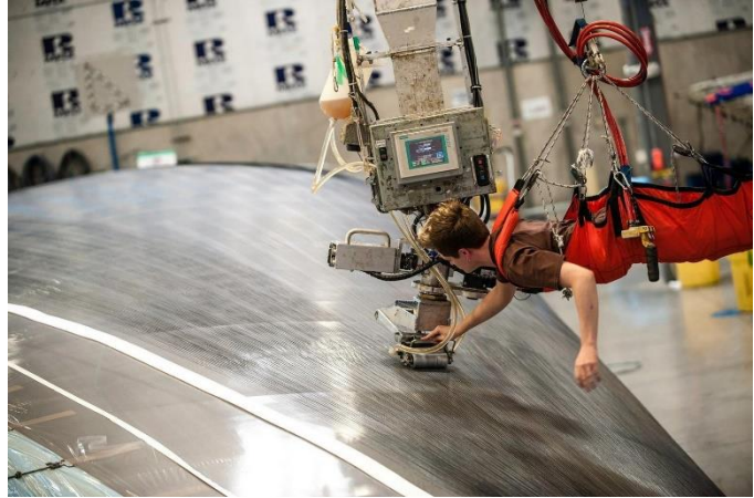
ŞEKİL 17:METAL AYAKLARLA ÜRETİLECEK YELKENİN ŞEKLİ VERİLDİKTEN SONRA VİNÇLER YARDIMIYLA ÜRETİM İŞLEMİ BAŞLANIR
