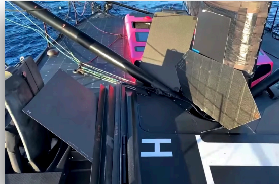
Fotoğraf 24. Alex Thomson, teknesindeki yapısal hasarı gidermek için karbon panelleri Hugo Boss'un güvertesine çıkarıyor,
