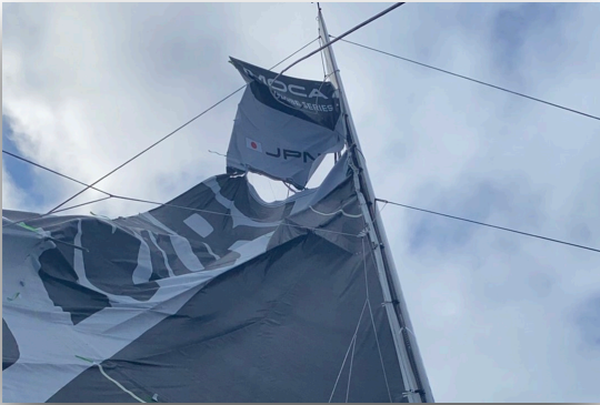
Fotoğraf 21. Bir otopilot arızası sonucu yanlışlıkla iki kez kavança atan DMG MORI Global One teknesinin ana yelkeni hasar alıyor, 14 Kasım 2020.
